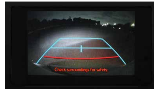
Monitor con cámara de estacionamiento.
