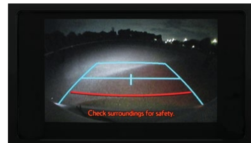
Monitor con cámara de estacionamiento.
