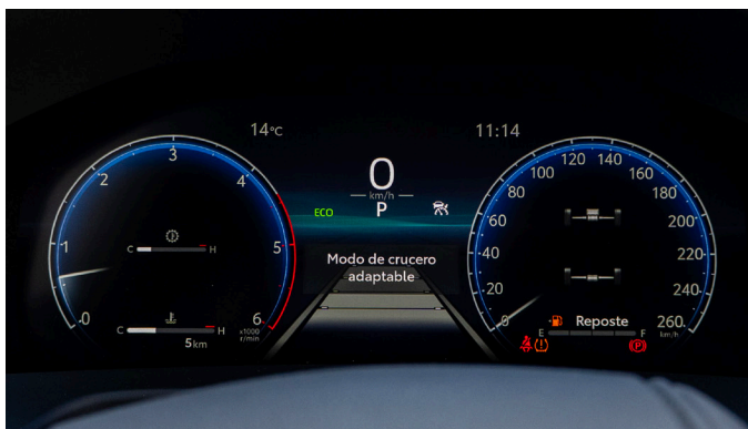
Display de información múltiple con pantalla a color de 12,3"
