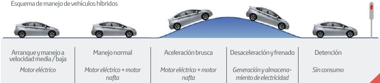
Esquema de manejo de vehículos híbridos
